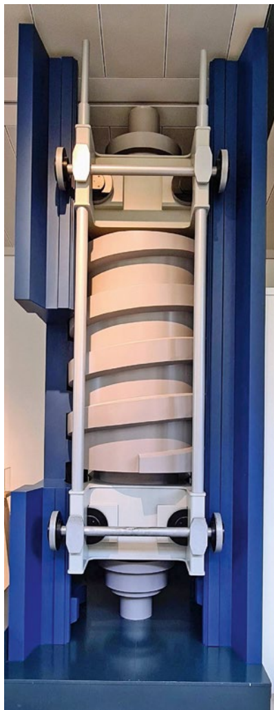
Model gwintowanej kolumny zaciskowej w Centrum Informacyjnym w Niederfinow
